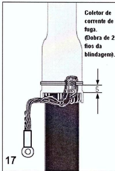
Use dois fios da malha de blindagem e os dobre para trás, na direção da ponta da terminação. Fixe-os com o fio de cobre estanhado que é fornecido, fazendo um coletor de corrente de fuga.
