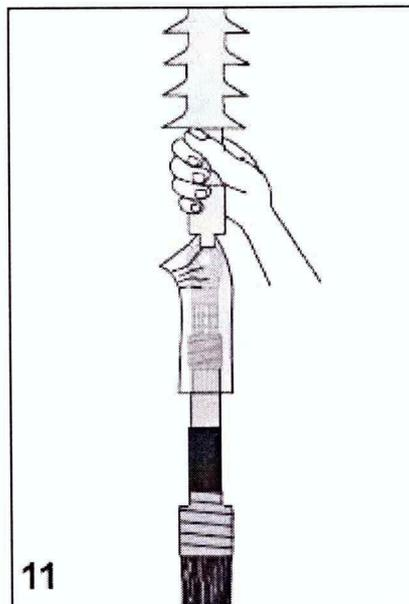
Deslize o corpo da terminação sobre o saco plástico de proteção para a instalação e sobre a isolamento do cabo.
