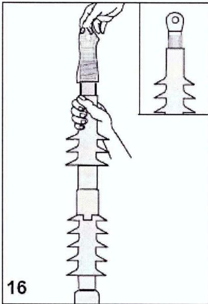
Empurre para baixo o corpo da terminação para remover o saco plástico de proteção. Mova-o de volta, cobrindo o mastic vermelho do barril do conector.
