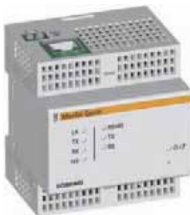
Servidor Sepam ECI850 para IEC 61850.
