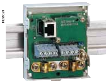
Interface de conexão da rede RS 485 de 2 fios ACE949-2.
