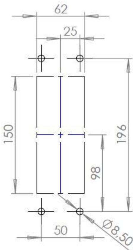
**Detalhe RASGO/FURAÇÃO de fixação**
