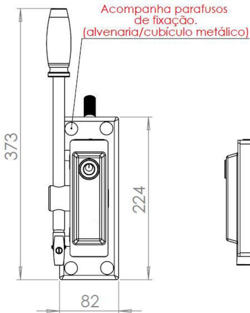
Pino roscado para regulagem rosca M16 com tubo de ligação/seccionador
