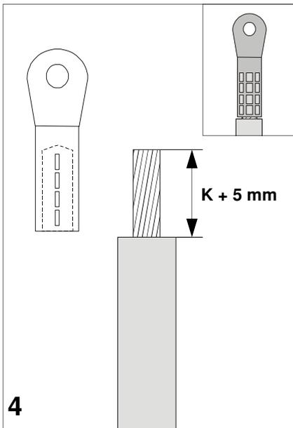
Corte a isolação de acordo com a dimensão **K** (**K = Profundidade do Barril + 5 mm**).
