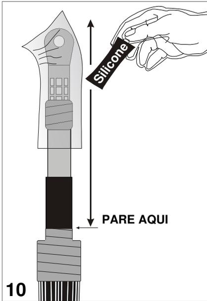
Posicione o saco plástico de proteção para a instalação no topo conector e aplique o silicone por toda a terminação, incluindo o saco plástico. Distribua bem o silicone por toda a superfície.
