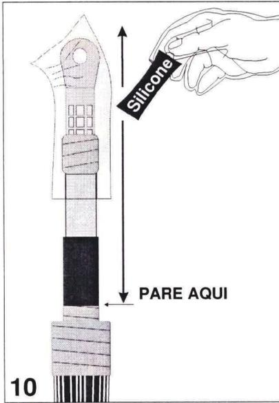
Posicione o saco plástico de proteção para a instalação no topo conector e aplique o silicone por toda a terminação, incluindo o saco plástico. Distribua bem o silicone por toda a superfície.
