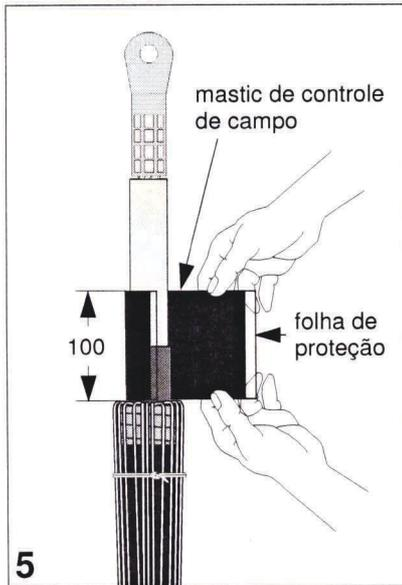
Retire uma das folhas de proteção do Mastic de controle de campo (**Verde ou preto**) e o aplique alinhado com o corte da camada semi-condutora. Enrole-o sobre o cabo como mostrado na fig. 5, removendo a outra folha de proteção.
