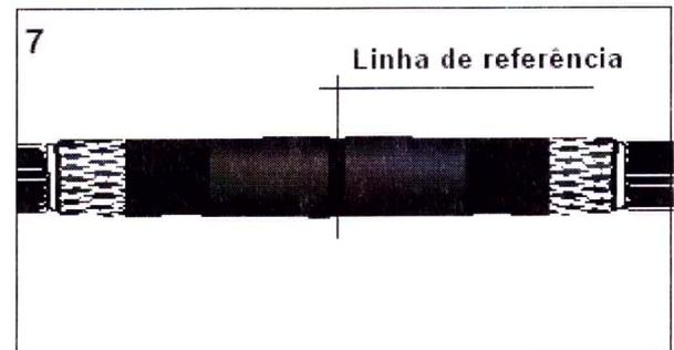
Dobre temporariamente os fios da blindagem para trás, sobre o módulo da emenda. Aplique a cinta mola pequena sobre a capa externa, dentro de uma área de 40 mm medida à partir do corte da capa externa.
